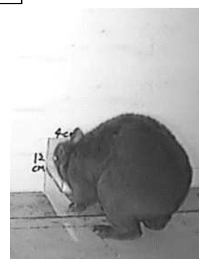
縦12 cm×横4 cmの隙間は 通り抜けできない
