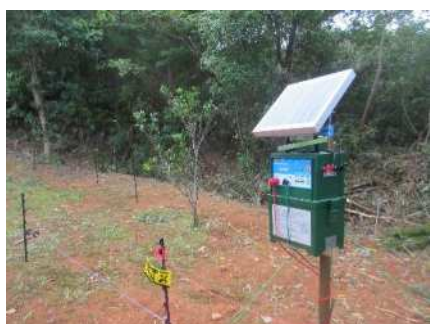
ソーラーパネルを太陽光がしっかりと当たる方向へ向ける
