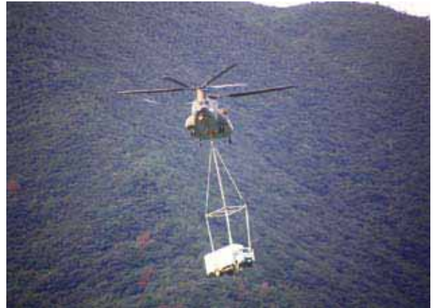
自衛隊大型ヘリコプターによる高圧発電機車の搬送 (大和村)
