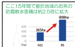
【散水氷結法：水が凍るときに発生する潜熱を利用して凍霜害を防止する手法】
