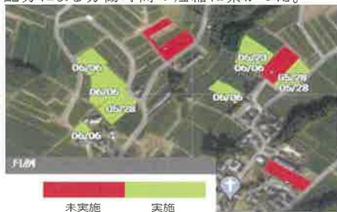
写真1 作業進捗度の確認例
