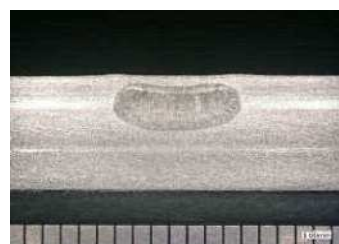
スポット溶接マクロ写真
