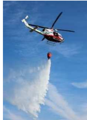
消火バケツ(バンビバケツ)による空中消火
