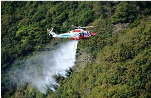
消火タンク(ドロップタンク)による空中消火
