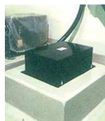
川内原子力発電所内岩盤上(建屋地下5階)の地震計【九州電力株式会社】
