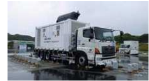
①可搬型ディーゼル注入ポンプ
