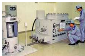
放射線を監視する装置の点検や調整試験等の訓練状況
