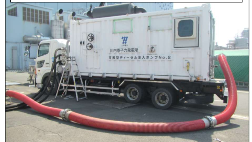
可搬型ディーゼル注入ポンプから 蒸気発生器2次側への注水（仮設ホース敷設）
