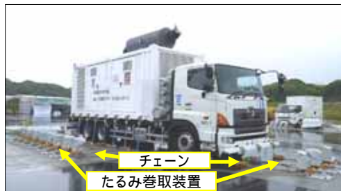
可搬型ディーゼル注入ポンプの固縛状況
