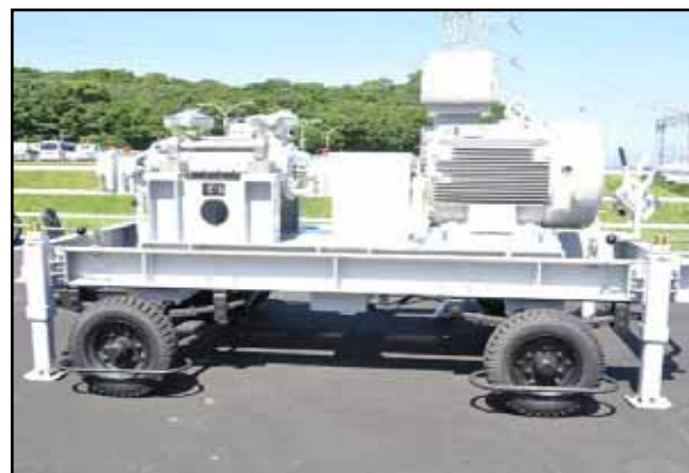
(B) 可搬型電動低圧注入ポンプ
