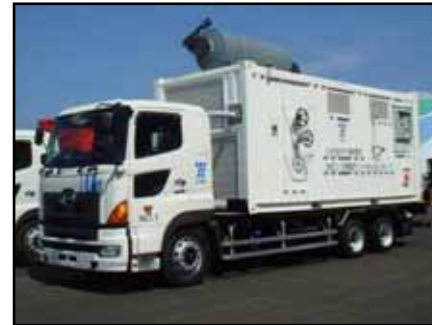
可搬型ディーゼル 注入ポンプ
