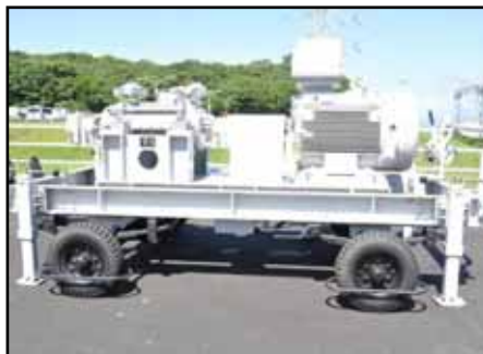
可搬型電動低圧注入ポンプ
