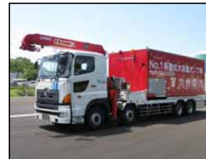
移動式大容量ポンプ車
