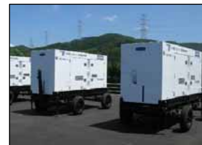
直流電源用発電機
