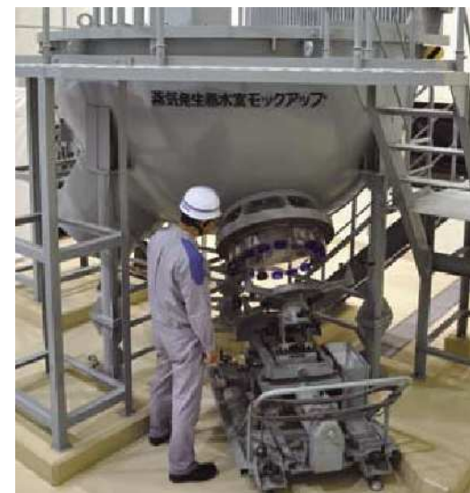
蒸気発生器水室を模擬した訓練用設備
