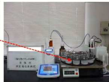
塩分の浸透を測定する機器
