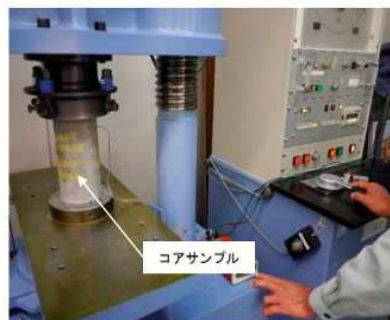
コアサンプルの圧縮強度の測定
