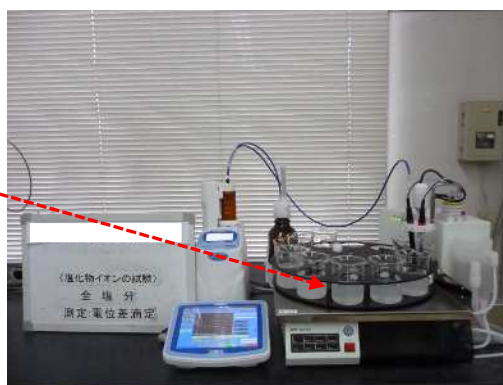
写真4.7 塩化物イオン量の測定状況
