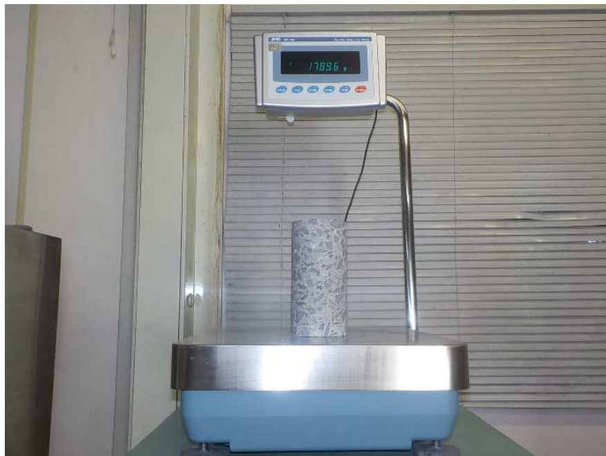
写真4.10 乾燥単位容積質量の測定状況
