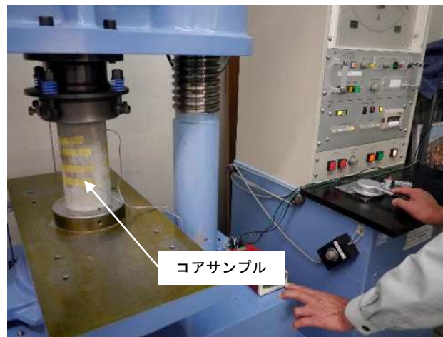
写真4.9 圧縮強度の測定状況
