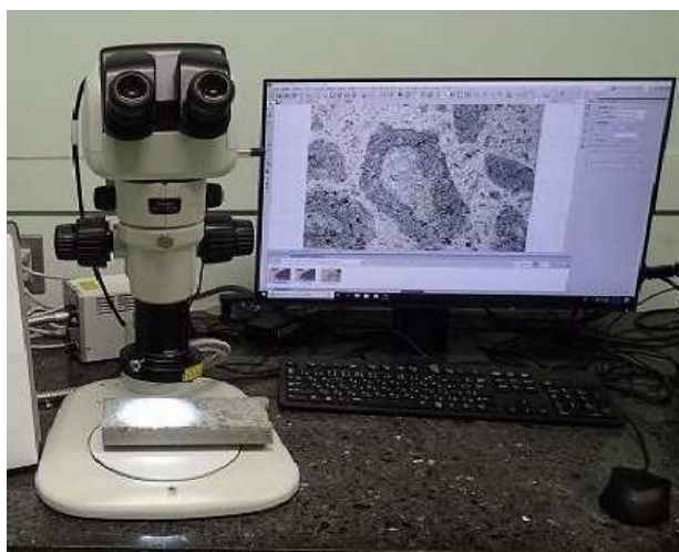
写真4.8 実体顕微鏡による観察状況
