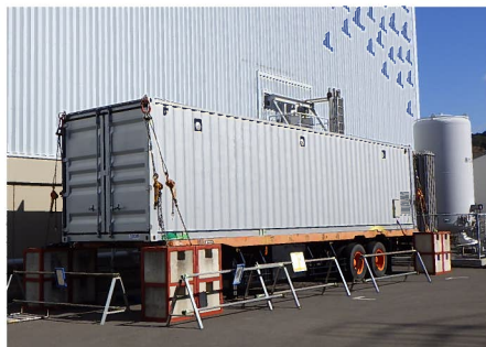
建屋外にある 遠隔操作用コンテナハウス
