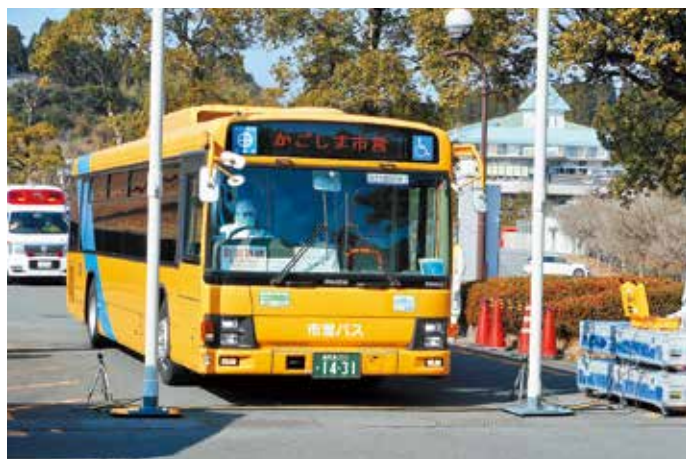
車両検査（ゲートモニタ）
