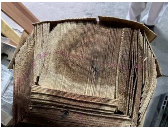
写真6 平木張りの材料および施工事例
