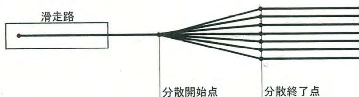
図 6.3-20 飛行経路分散の考え方
