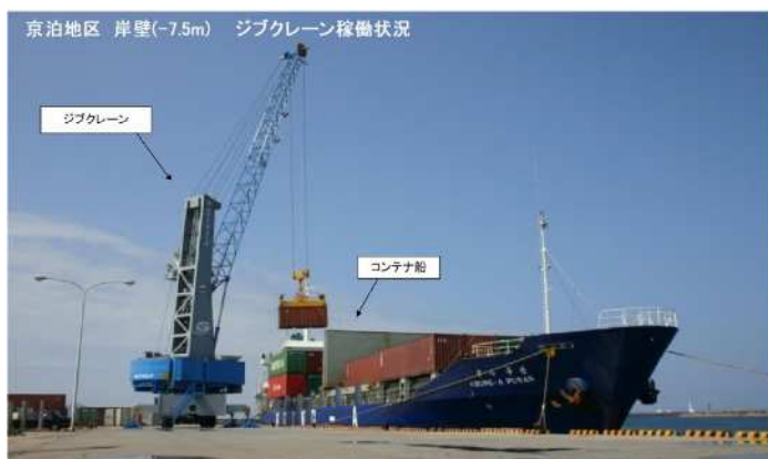
京泊地区 ジブクレーンによるコンテナ船への積込状況
