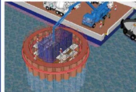
鋼管矢板井筒内に鉄筋コンクリート製の橋脚本体を造ります。
