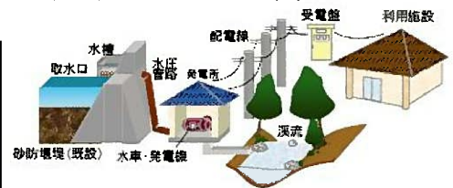
砂防堰堤を活用した小水力発電の一例
