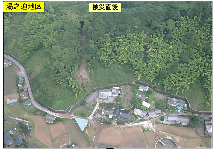
施設効果 落石防護柵が流木を受け止めている
