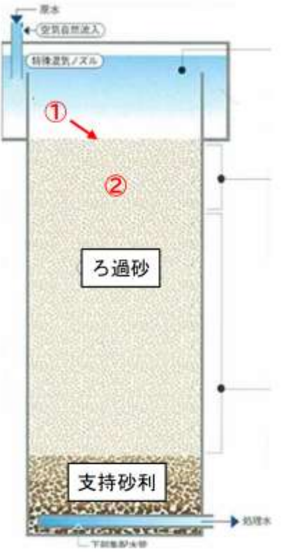
処理装置内ろ過材への土砂混入状況
