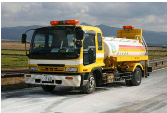
散水車（九州地区整備局より貸与）
