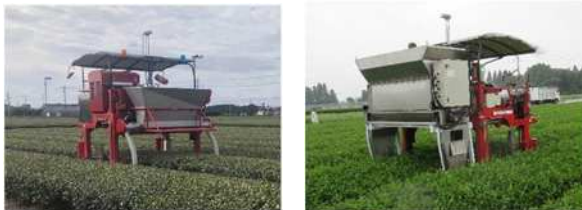
図1 ロボット施肥機のアタッチメント (左:普通肥料用, 右:堆肥用)
