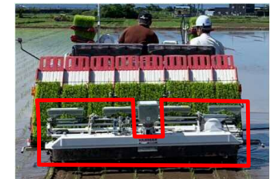
側条施薬機(赤線内)による側条施用
