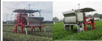
ロボット施肥機のアタッチメント (左:普通肥料用, 右:堆肥用)
