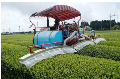
従来防除機にもアタッチ装着可能な「かごしま式防除装置」
