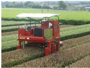
開発したロボット中切機
