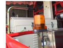
◆緊急停止用送受信アンテナ (非常時にエンジンを遠隔操作で停止)
