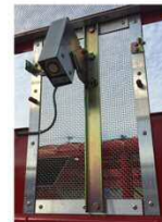
◆収穫センサー (摘採量を認識)
