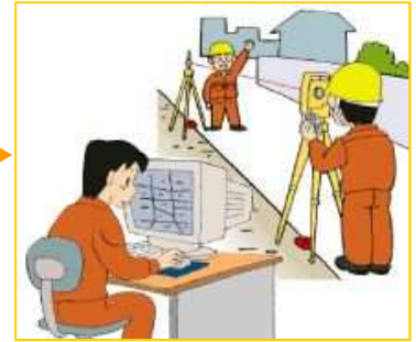
③地籍測量 地球上の座標値と結び付けた、一筆毎の正確な測量を行います。
