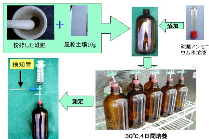
図IV-3-(5)-1 二酸化炭素発生量の測定法
