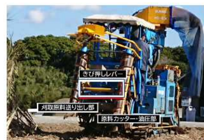
開発したアタッチメントを取り付けたケーンハーベスタ試作機
