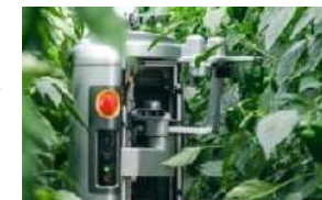
実証中のピーマン自動収穫機
