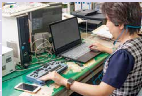
文書を音声で聞き、左手の点字ディスプレイで点字変換を行います。入力文字の漢字への変換も、音声で確認して行います。
