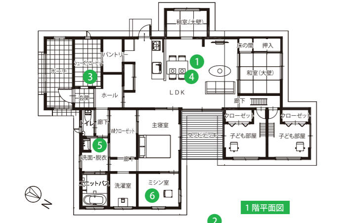
●家族構成/夫婦2人+子ども2人 規模/木造平屋建て ●敷地面積/394.07㎡ 建築面積/131.94㎡ 延床面積/123.66㎡ ●竣工年月/2019年5月
