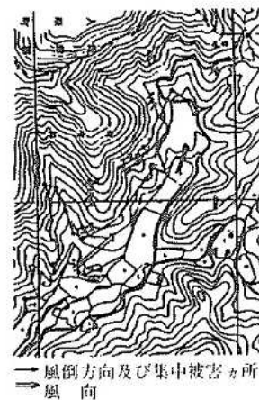
図-11 山間部の水田に面した斜面の被害 (台風13号)
