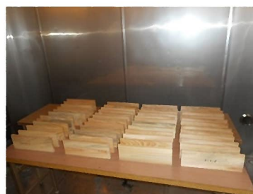
写真1 試験体設置状況 (恒温恒湿器内)
