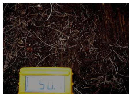
写真10 ゼラニウムの堆積物下の床板 (MC50%)
