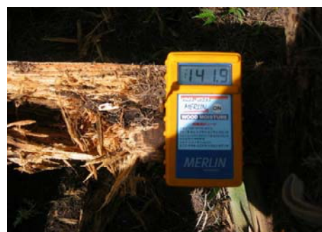
写真11 腐朽や食害のある根太 (MC42%)
