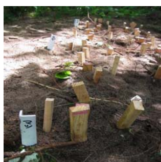
写真2 試験杭の設置状況
