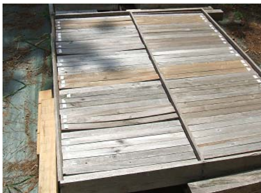
写真 1 試験体の設置及び反りの発生状況 (左側がリュウキュウマツ)
