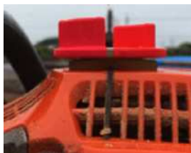
ガンマークを立体的に視覚化することができるので、初心者の方にも簡単にガンマークが示す方向が分かります
