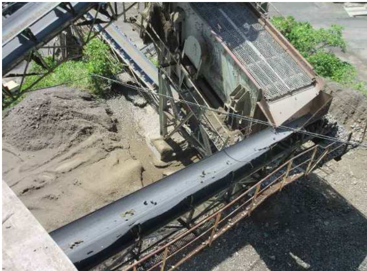
オーバーサイズ戻り *40mm以上は再び2次破碎 (シュレッダーへ)
