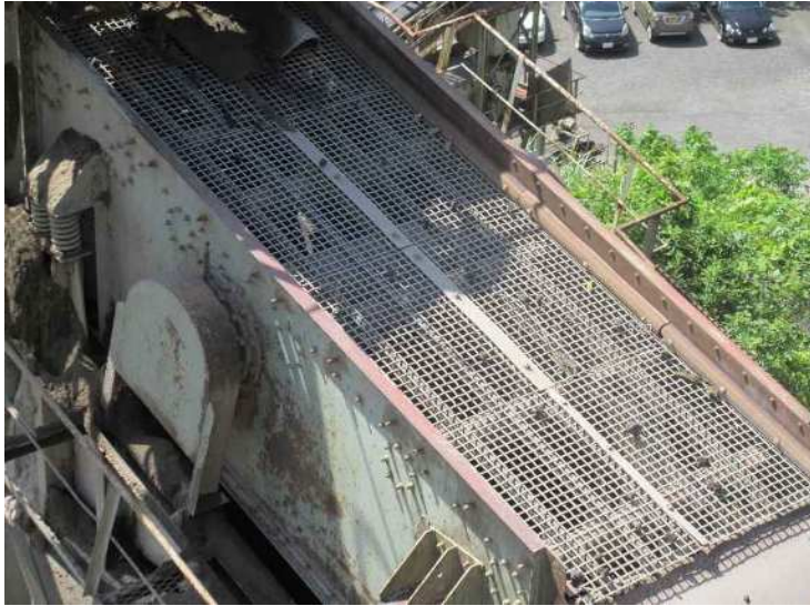
振動篩（40mm*40mm） *ここで40mm以下は 篩を通過後、製品落ち口へ
