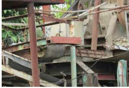
破碎後に磁選機及び手作業にて鉄筋等の異物除去
