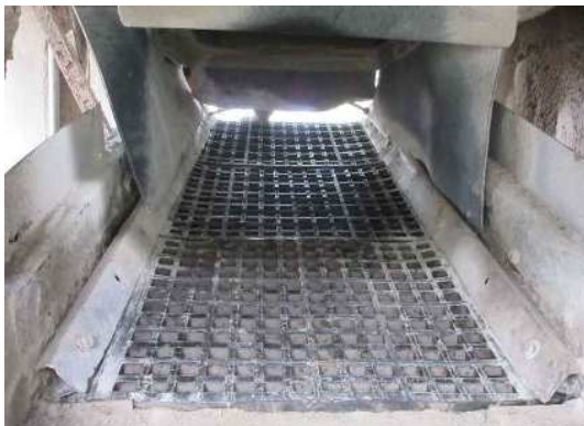
30mmスクリーンで選別 30mm以上は一次破砕機ヘリターン
