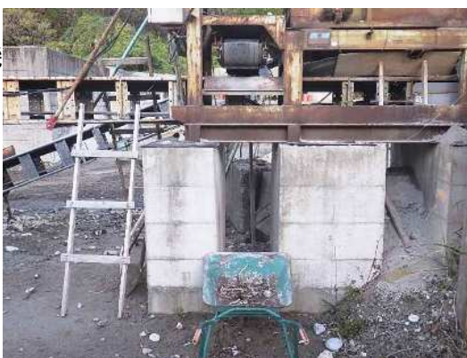
・磁選機 破碎機に装着した磁選機 金属類の除去
