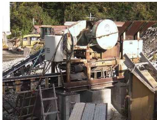
ジョークラッシャー ・破碎 ・破碎機中山鉄工所製 HFA4M
