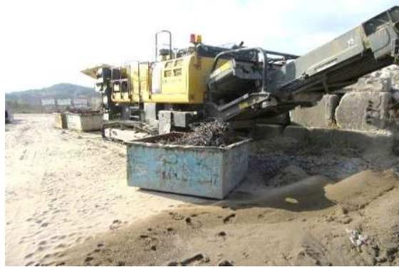
磁選機による金属類の除去状況
