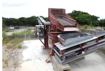
⑧振動ふるい機で選別 ・ふるい機のスクリーンで粒度選別 ・40mmスクリーンを通過したものがRC-40 ・オーバーサイズはクラッシャーへリターン
