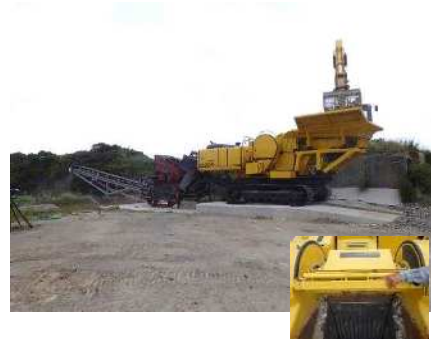
⑥クラッシャーへ投入し破碎 ・コマツ製作所製ジョークラッシャーBR210JG
