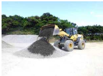
⑩再生材と新材の混合 ・RC-30(Co50%,As20%)と新材碎石を タイヤショベルで7杯、3杯の割合で 計量・混合して製品とする
