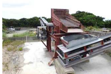
⑧振動ふるい機で選別 ・ふるい機のスクリーンで粒度選別 ・30mmスクリーンを通過したものがRC-30 ・オーバーサイズはクラッシャーへリターン
