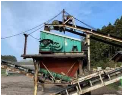
⑪ 振動ふるい機で選別 ・振り機で粒度選別 ・40mmスクリーンを通過したものがRC-40 ・オーバーサイズはクラッシャーへリターン
