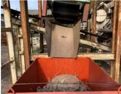
⑩ 磁選機で金属類の除去 ・破砕後に磁選機で金属等の除去
