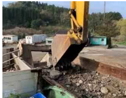
⑥第1クラッシャーへ投入 ・ラサ工業製ジョークラッシャー
