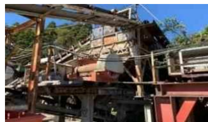
⑦第1ベルトコンベアー ・第一クラッシャーでの破碎後 ベルトコンベアで第2クラッシャーへ
