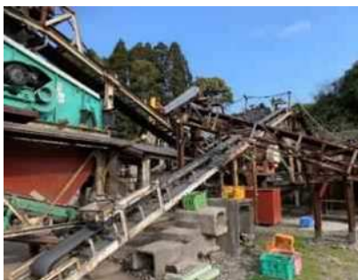
⑫ 第2・3ベルトコンベアー ・オーバーサイズはベルトコンベアーでクラッシャーへリターン ・第2クラッシャーで再度破砕
