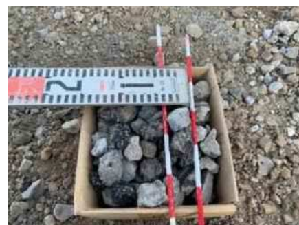
⑯ 製品 ・RC-40 配合割合 がれき類 (Co50% As30%) 新材20%
