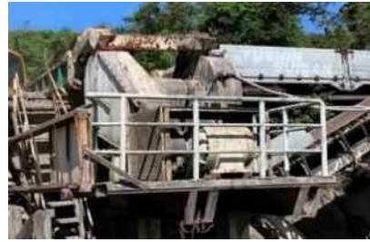
⑥第1クラッシャーへ投入 ・ラサ工業製ジョークラッシャー
